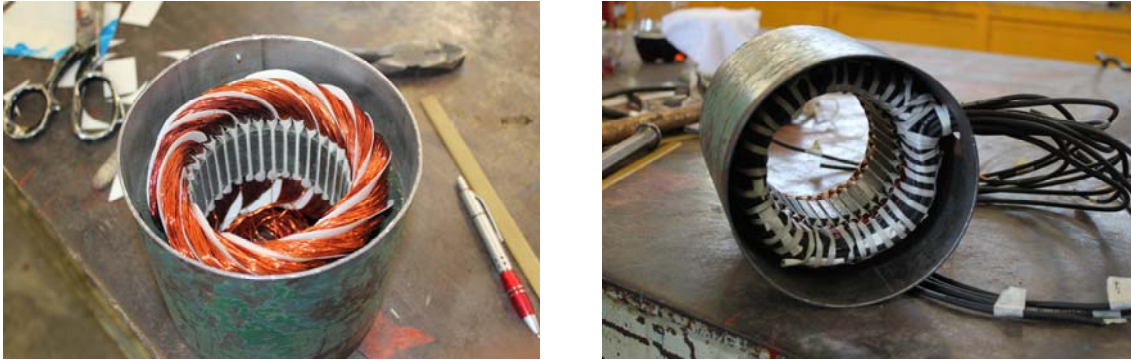
Figura. C.1 Motor prototipo. Lado izquierdo: aislamiento entre grupos. Lado derecho: 12 terminales al exterior.
